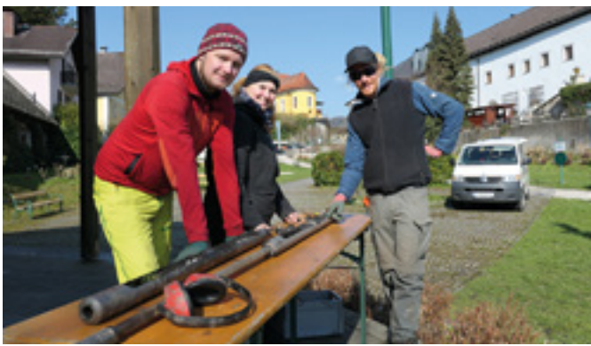
Rammkernsondage im Klostergarten. Pile core probing in the monastery garden.
